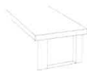
Lucarne à un pan de toit soulevé
